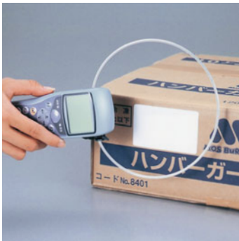
納品ケースに貼りつけられたICタグと読み取り機
