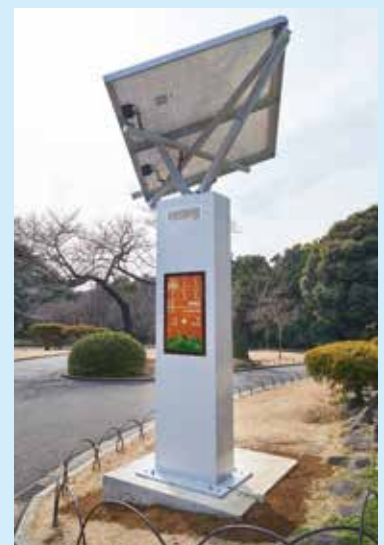
新宿御苑に設置した、太陽光発電で稼働するデジタルサイネージ
