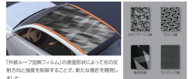
「外装ルーフ加飾フィルム」の表面形状によって光の反射方向と強度を制御することで、新たな意匠を開発しました。
