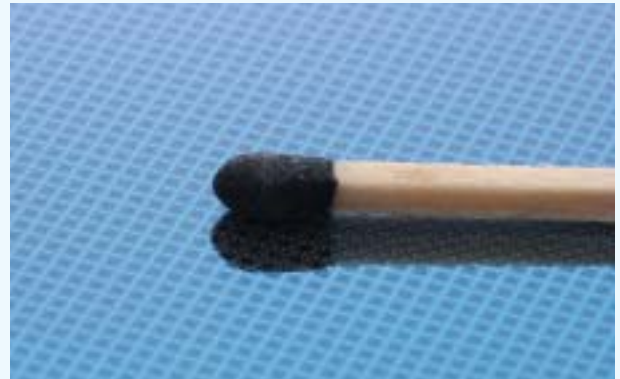
MEMS：正方形の1枚1枚が約0.9mm角のセンサーチップ
