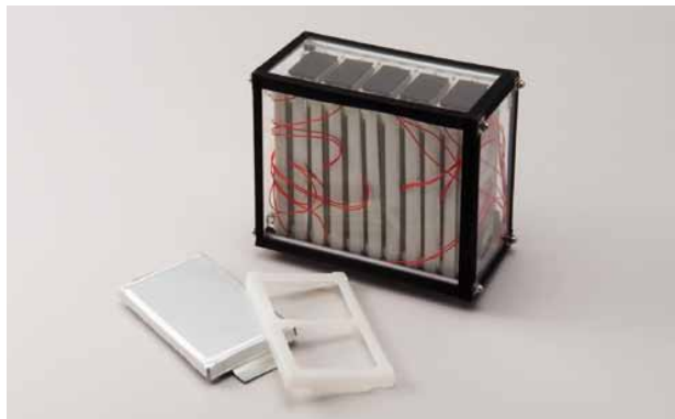
電気自動車等に使用される大型のリチウムイオン電池は、複数のソフトパックをさらにパッケージ化しています。
