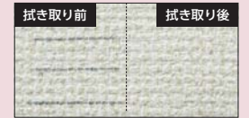
水性ペンで線を引き、24時間後に合成洗剤と水で拭き取った状態
